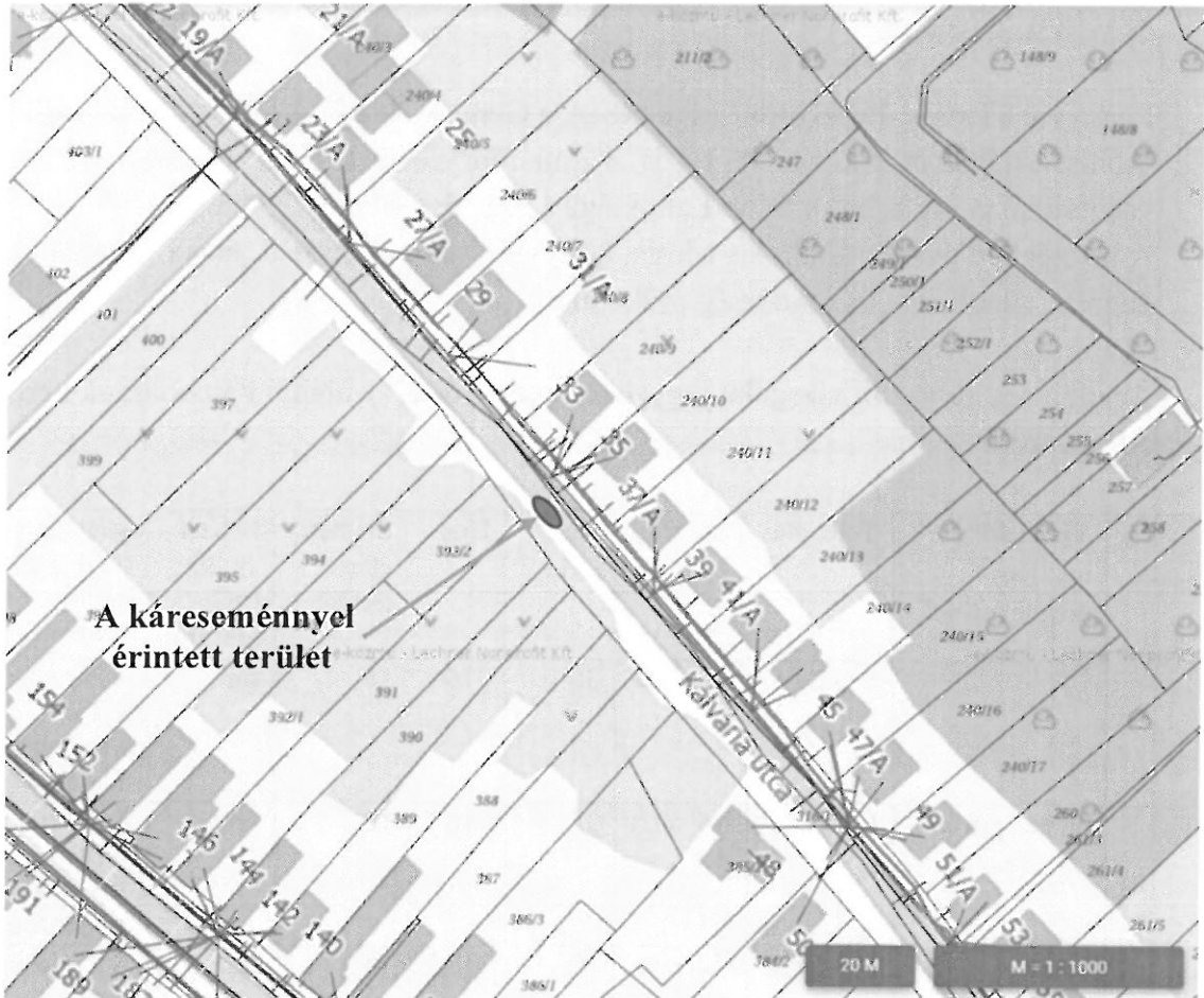
1. ábra – a Kálvária utcai suvadással érintett terület közműterképe az E-közmű nyilvántartása szerint
